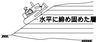
(a) ブルドーザによる締め固め (のり勾配の緩いとき)
