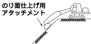
(c) バックホウによるのり面締め固め
