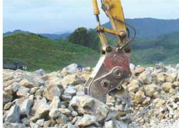
写真-5 コンクリート破壊機（ニブラ）
