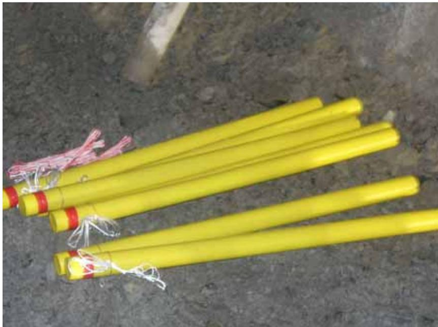
写真1：蒸気圧破碎薬剤 / ガンサイザー
