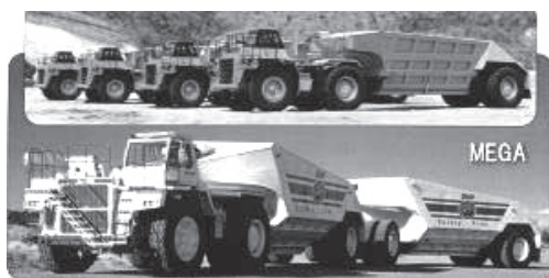
写真—44 トレーラ式ボトムダンプ
