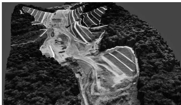
図—16 3D モデルの Acrobat 出力例（高速道路工事） 3)
