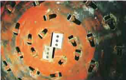
新機能である厚さ2.54cmのT-1鋼板製チッパー円板の表面。
