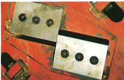
新機能であるカーバイト刃と鋼板製刃でできた使い捨て二枚刃。
