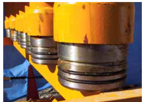
写真-9. トレミージョイント部
